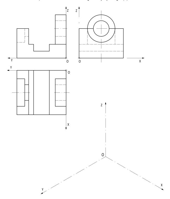
Ajustándose a los ejes del Sistema que se facilitan, representar a escala 1:1 el Dibujo Isométrico (sin coeficiente de reducción) de la pieza dada por sus proyecciones. Tomar las medidas directamente de las vistas y no dibujar la líneas ocultas. La representación debe orientarse según los ejes y el origen (O) indicados.
