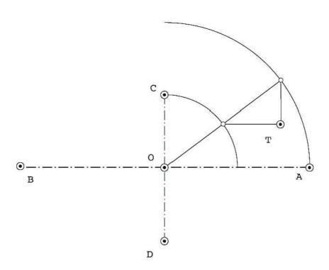
Trácese la recta tangente a la elipse en el punto **T**, determinado en la misma, partiendo del conocimiento de sus ejes **AB-CD** y sin trazar la curva.
